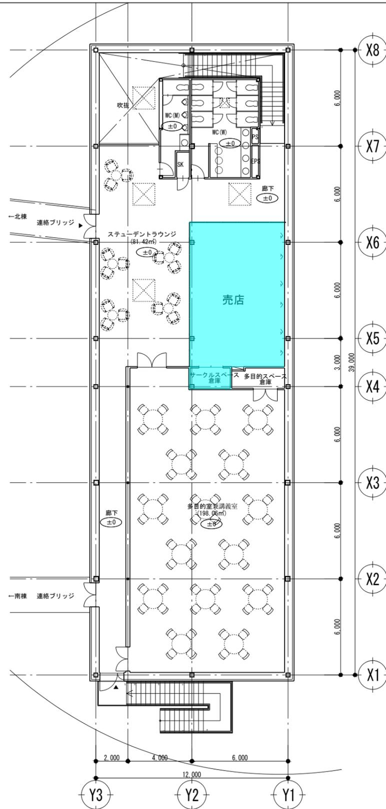
2階平面図 1/100 ±0 : 床レベルを示す。(mm) 基準2FL=±0 (=GL+3950) 廊内消火栓 (水平距離25m以下)
