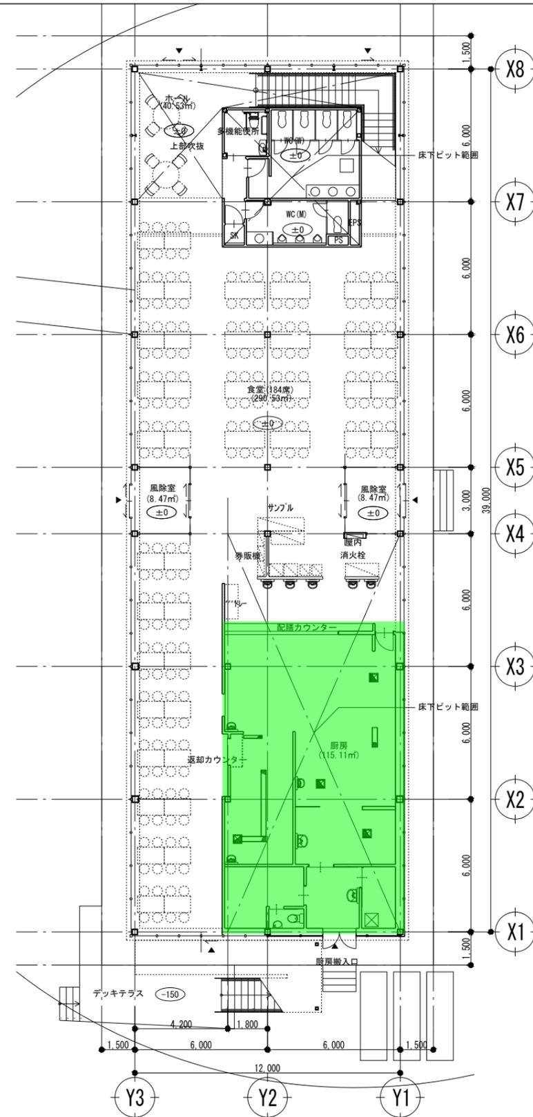
1階平面図 1/100 ±0 : 床レベルを示す。(mm) 基準1FL=±0 (=GL+50) 廊内消火栓 (水平距離25m以下)
