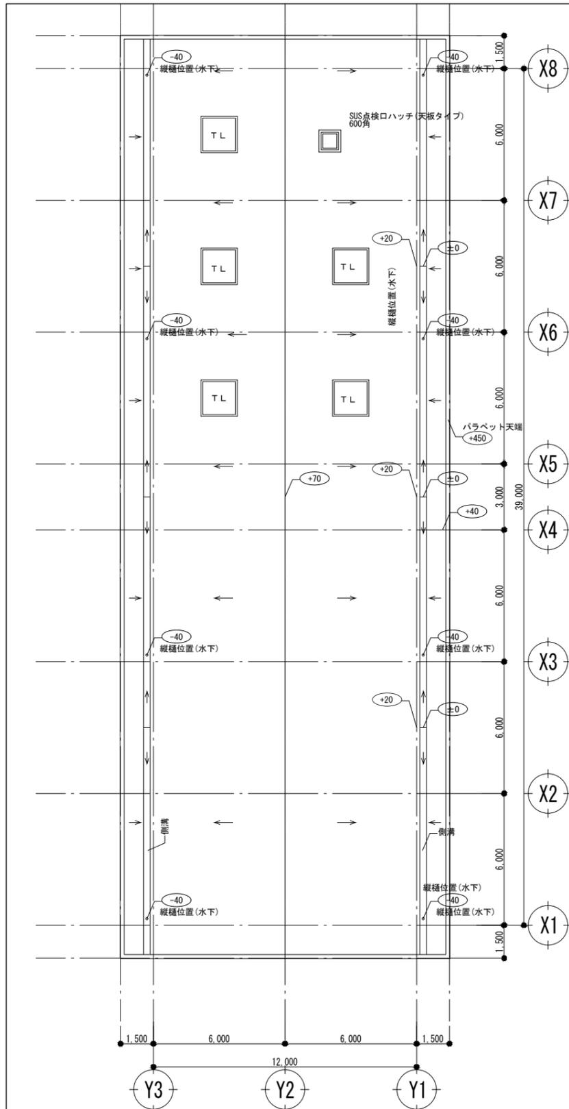
屋根伏図 1/100 ±0 : 床レベルを示す。(mm) 基準RFL=±0 (=GL+7830)
